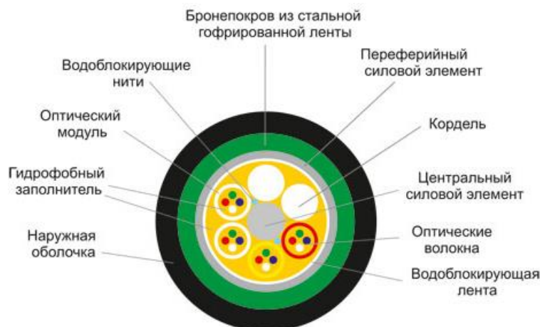
Рисунок 2.11.6.6 - Пример конструкции ВОК для прокладки в зданиях
